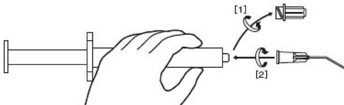
Дозируйте материал умеренным надавливанием на поршень шприца. Никогда не совершайте обратного движения поршня шприца, так как это может привести к контаминации композита. Снимите и утилизируйте использованный наконечник, вытрите кончик шприца салфеткой и немедленно закройте шприц колпачком.
